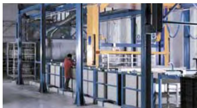
Il nostro impianto di lavaggio e verniciatura lavorati in materiale pressofuso (lega di alluminio) nell'unità produttiva di Castel Gelfo (Bologna) / Our die-cast material (alloy and aluminium) washing and painting facility at the Castel Gelfo works (Bologna)
