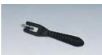
Ruotina infila guarnizioni / Sealing strip inserter wheel
